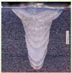
最大出力4.5kW(FH-450)の高出力で、レーザならではの低ひずみ溶接と深い溶込みを同時に実現しました。
