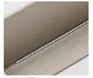
■チタン 板厚t1.0 T字継手溶接
